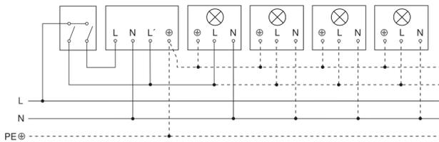
Schaltplan Anschluss über einen Wechselschalter für Dauerlicht- und Automatik-Betrieb
