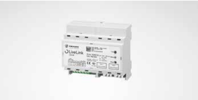
Hutschienencontroller LiveLink LAN DR • DALI-2 APC max. 64 Teilnehmer • Inbetriebnahme per Wlan und App • Anbindung an übergeordnete Systeme via MQTT EAN 4007841 055455
