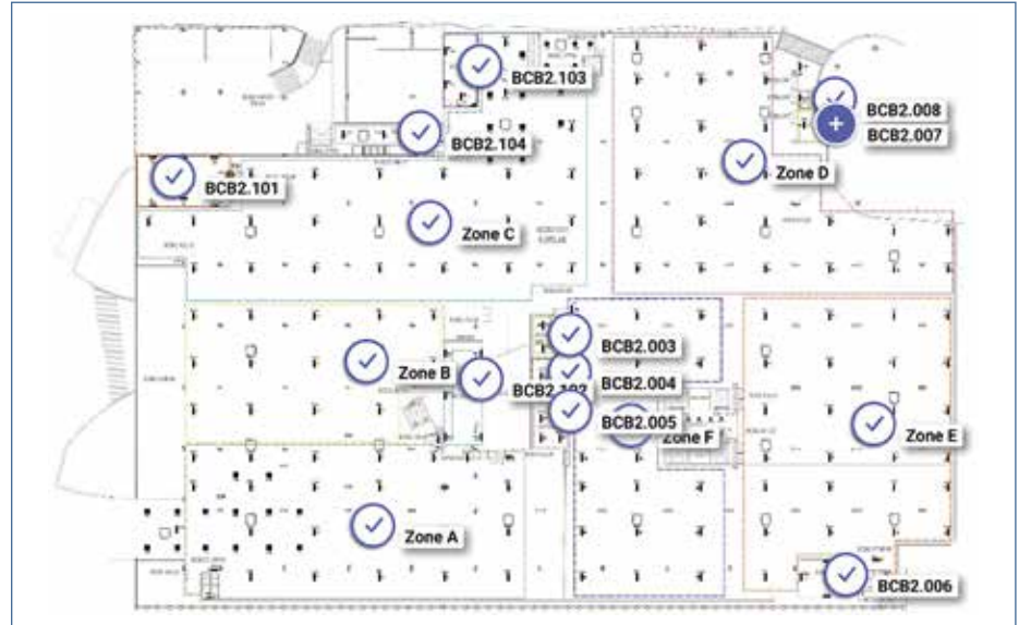
Bild 1: Vernetzte Beleuchtungssensoren registrieren zonenengenau Anwesenheiten und können über Apps für Smartphones gesteuert werden.
