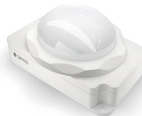
Überwachung auf höchstem Niveau. Infrarot-Bewegungsmelder für innen. Ideal für eine rechteckige Erfassung aus grossen Höhen in Lagerhallen, Hochregallager, Maschinenhallen, Abfertigungs- und Wartehallen. Montagehöhe von 4m bis zu 14m, Erfassungsfeld 30 x 4m (radiale Bewegung).
