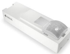
Klein. Flach. Kompakt. Unauffälliger Präsenzmelder. 360°-Passiv-Infrarot-Sensor mit einem Präsenzbereich von 4 x 4m (Präsenz und radiale Bewegung) bzw. 6 x 6m (tangentiale Bewegung). Mit patentierter Fresnellinse.
