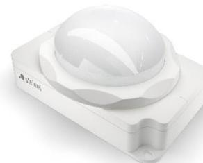
Überwachung auf höchstem Niveau. Infrarot-Bewegungsmelder für innen. Ideal für eine rechteckige Erfassung aus grossen Höhen in Lagerhallen, Hochregallager, Maschinenhallen, Abfertigungs- und Wartehallen, Montagehöhe von 4m bis zu 14m, Erfassungsfeld 30 x 4m (radiale Bewegung), bei der Präsenzschwelle 100 und 20 x 4m (radiale Bewegung) bei der Präsenzschwelle 200.
